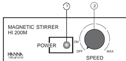
1. **Indicación de Alimentación** (Al conectarlo se ilumina el indicador LED)
