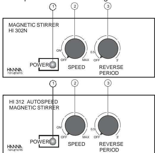
1. **Indicación de Alimentación** (Al conectarlo se ilumina el indicador LED)
