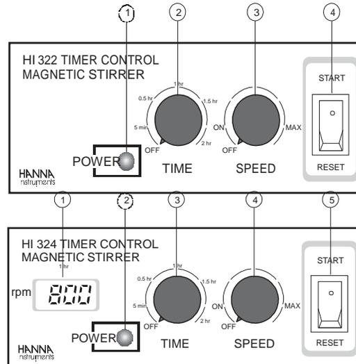
1. **La pantalla rpm** muestra velocidad rpm.
