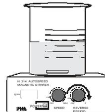
E.g. si lo fija en un minuto, el fluido girará en una dirección durante un minuto y después invertirá su rotación durante otro minuto en un ciclo repetido hasta que apague el mezclador.
