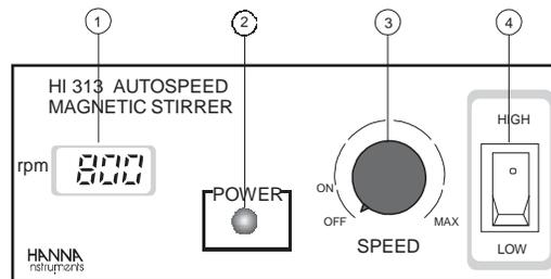
1. **La pantalla rpm** muestra velocidad rpm.
