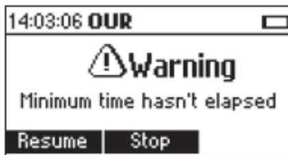
instrumento desplegará un mensaje de advertencia. Presione **Resume** para continuar con la prueba o **Stop** para terminar con la prueba. Al comienzo de la prueba el medidor desplegará el valor calculado OUR y la duración de la prueba.
