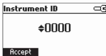
Utilice las teclas **ARROW** para cambiar la identificación (ID) del instrumento. Presione **Accept** para confirmar o **ESC** para salir sin guardar los cambios.
