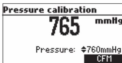
Presione CFM para confirmar la calibración.
