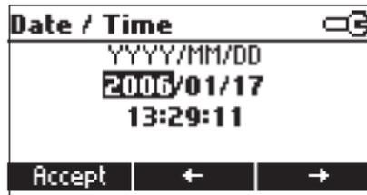
Utilice las teclas ←/→ para seleccionar el ítem. Utilice las teclas ARROW para cambiar los valores seleccionados.
