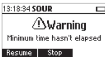
Presione **Resume** para continuar la prueba o **Stop** para detener la prueba.
