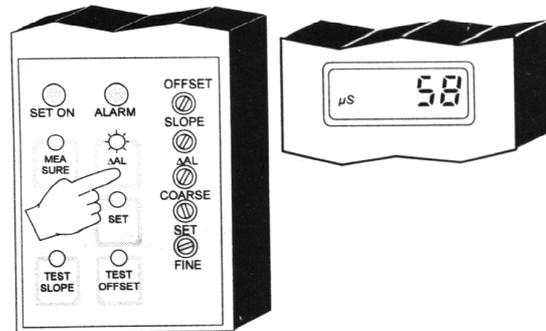
Por ejemplo, si el valor determinado por el punto de consigna es 200  $\mu\text{S}$  y la tolerancia de la alarma es 50  $\mu\text{S}$  el relé de alarma se abrirá al sobrepasar el valor por debajo de 150  $\mu\text{S}$  y por encima de 250  $\mu\text{S}$ . Mientras las lecturas se mantengan dentro del margen el relé permanecerá cerrado. El LED de la parte superior que permanecerá encendido indicando que el relé de la alarma está activado.
